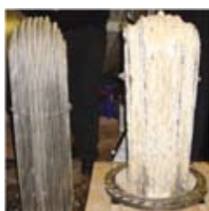
Beépíthető fűtőbetét 12 hónap üzem után: teljes egészében vízköves. Bal oldali képen: új, tartalék hőcserélő
