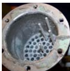
ECOTHERM magas hatásfokú hőcserélő 12 hónap üzem után: gyakorlatilag vízkőmentes
