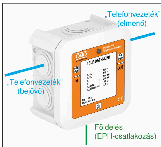
14. ábra: TD-4/I sorozatjelű túlfeszültség-védelmi eszköz beépítése az 1 vagy 2 érpáros „telefonvezetékbe”. Ügyelni kell arra, hogy a szolgáltatótól érkező vezetéket az eszköz bemenő („IN”) oldalára csatlakoztassuk.
