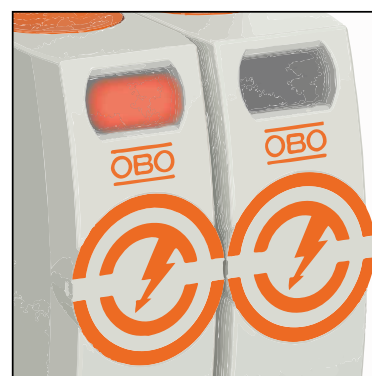
10. ábra: A betét meghibásodását a kijelző vörös színre váltása jelzi (balra).
