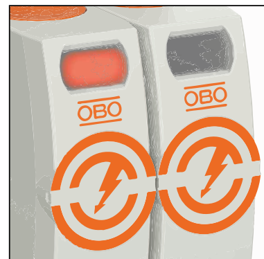
9. ábra: A betét meghibásodását a kijelző vörös színre váltása jelzi (balra).
