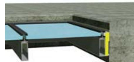
*PENEDERhorizontal wird speziell unter Lichtkuppeln und Lichtbändern in die Decke eingebaut, um bei Brandabschnitten die vorgeschriebenen Feuerwiderstandsklassen zu erreichen und trotzdem eine natürliche Beleuchtung im Raum zu ermöglichen.*
